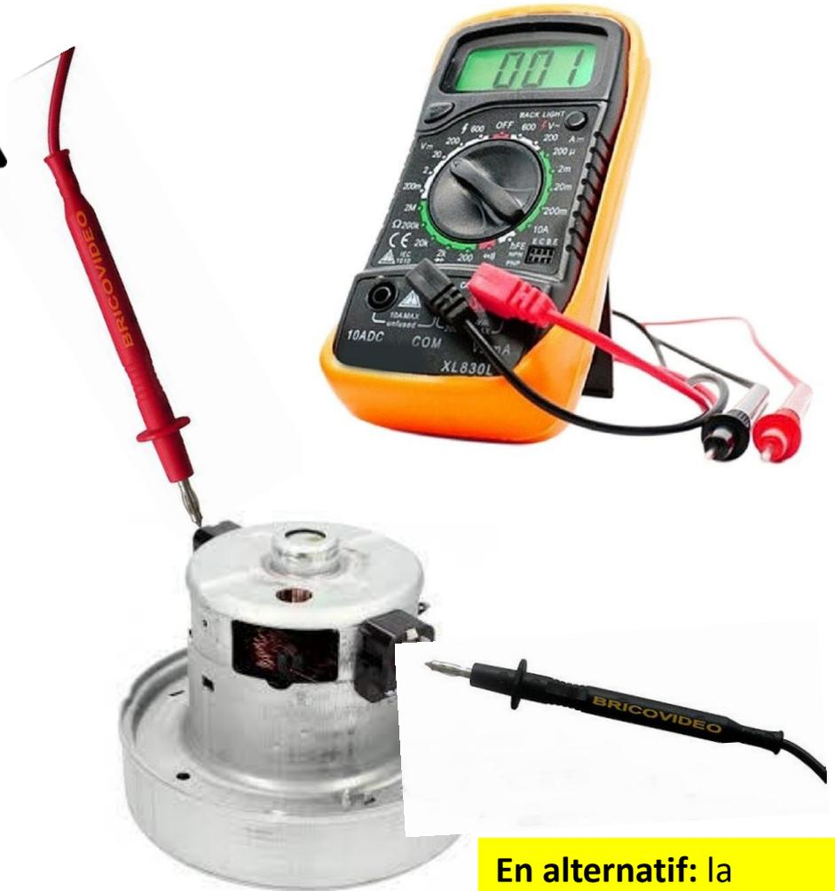
**En alternatif:** la tension mesurée par le multimètre est la tension efficace
