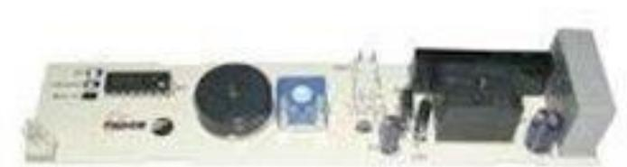
Ce type d'alimentation ne présente pas d'isolation galvanique entre la partie basse tension et les phases du secteur, risque d'électrisation!
